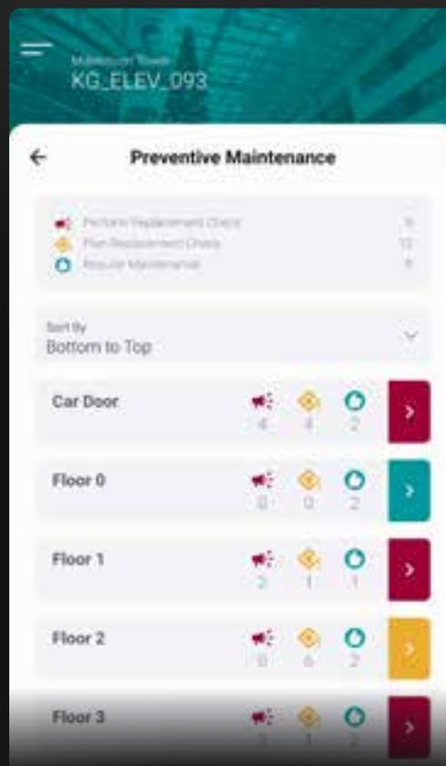
La manutenzione preventiva aiuta i tecnici di campo ad individuare precocemente i sintomi di malfunzionamento dei componenti e ad identificare in anticipo le parti che potrebbero necessitare di sostituzione, in base al loro stato di usura previsto. Ciò contribuisce a ridurre i tempi di fermo non programmato e a massimizzare la disponibilità dell'ascensore.
